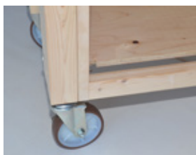
ひのぎ合板12mmを乗せるだけの構造です。
